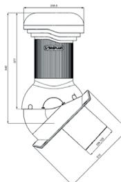
Инженерная система вывода конденсата позволяет ему стечь с вентиляционного выхода на кровлю, обеспечивает оптимальную продуктивность для вентиляции и защиту от влаги, которая попадает вместе с ветром, осадками в воздуховод.
