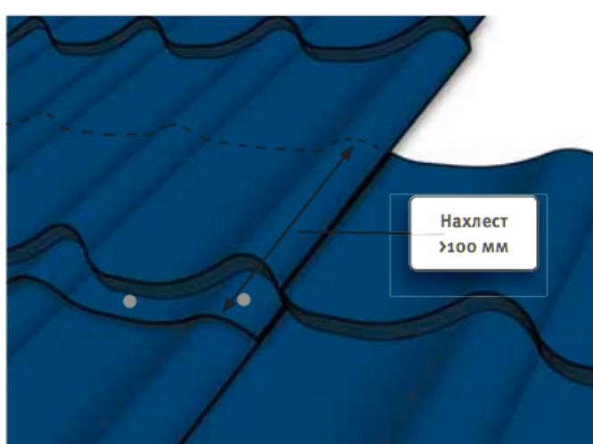
Листы металлической черепицы при наращивании соединяют вдоль ската с нахлестом минимум 100 мм и крепят к обрешетке в низ каждой продольной волны под поперечную волну профиля.
