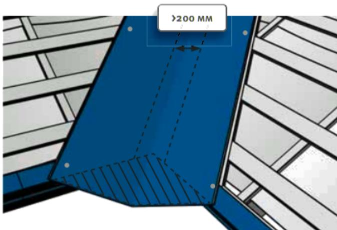
Затем установите угловой лист ендовы на свое место. Закрепите лист с помощью оцинкованных саморезов. Угловой лист ендовы следует укладывать внахлест не менее 200 мм на стыках. Рекомендуется использовать элемент гидроизоляции для нахлестов.
